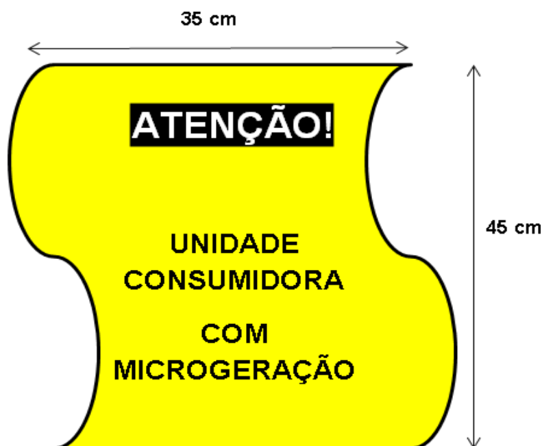
Figura 8 - Modelo de bandeira para o ramal de ligação da unidade com microgeração
