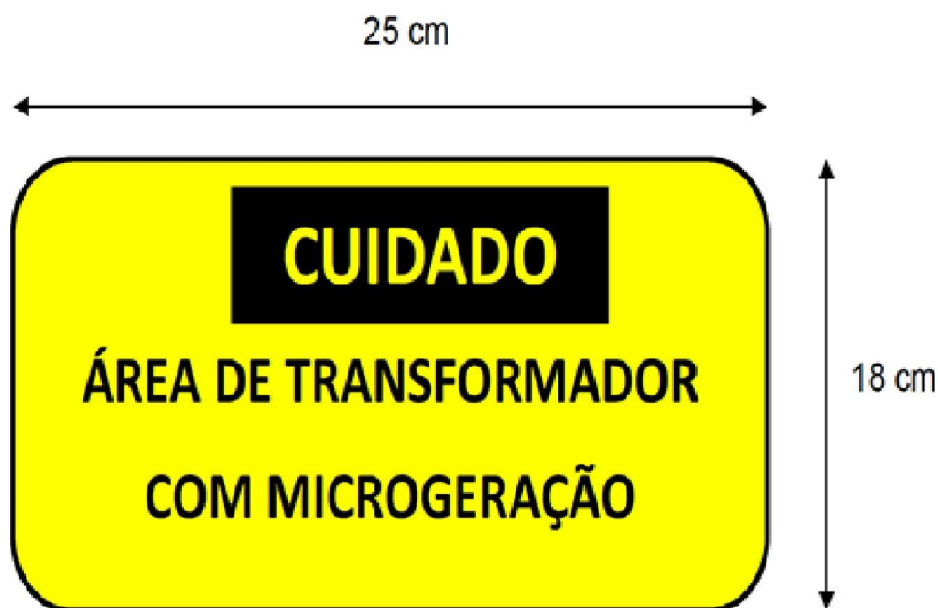
Figura 7 – Modelo das placas de sinalização para transformador de distribuição
